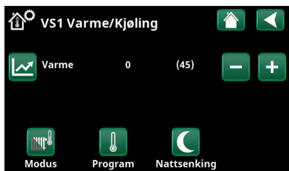
Menyen «Avansert/Definere/Varmesystem/Varmesystem 1». Varmesystemet har ikke romføler. Børverdien vises i parentes (turledningstemperatur 45\text{ }^{\circ}\text{C} ). Til venstre for børverdien vises utetemperaturen ( 0\text{ }^{\circ}\text{C} ) ved aktuell turledningstemperatur.
