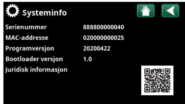
Meny «Avansert/Systeminformasjon». For å åpne denne menyen klikker du på knappen «i» nederst til høyre i menyen «Avansert».
