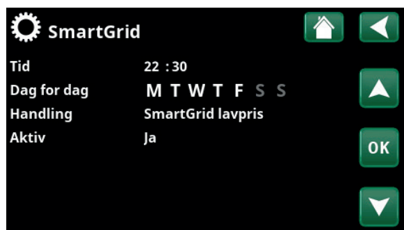
SmartGrid-funksjonen «SG lavpris» planlegges hverdager klokken 22.30–06.00. Gå til menyen ved å velge «SmartGrid-ukeprogram» i menyen «Avansert/Innstillinger».
